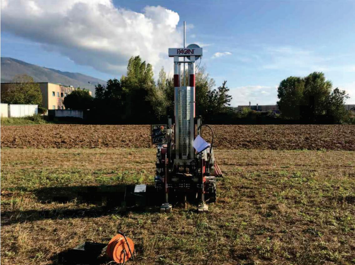
FOTO 1: Strumentazione utilizzata per l'esecuzione della prova DPSH 2.
