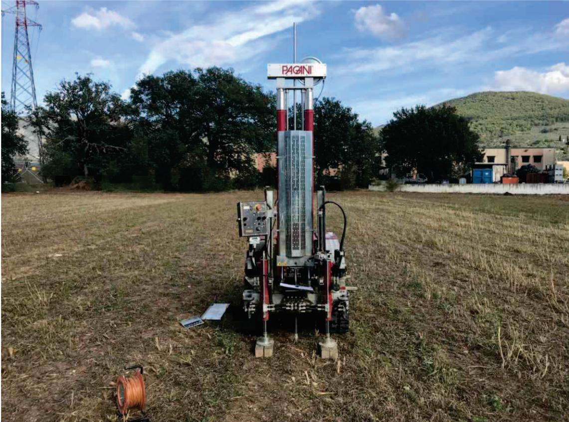
FOTO 1: Strumentazione utilizzata per l'esecuzione della prova DPSH 1.
